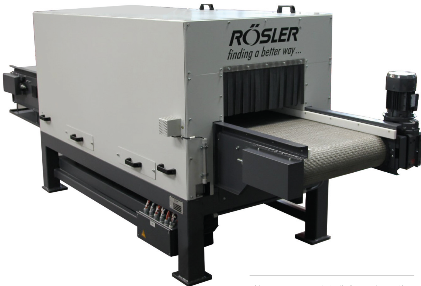
Sécheur avec une puissance de chauffe allant jusqu'à 75 kW, débit d'air jusqu'à 9000 m 3 par heure et une température maxi de 150°C.
